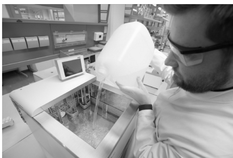
Fig. 5 : Remplissage du bain thermostaté
