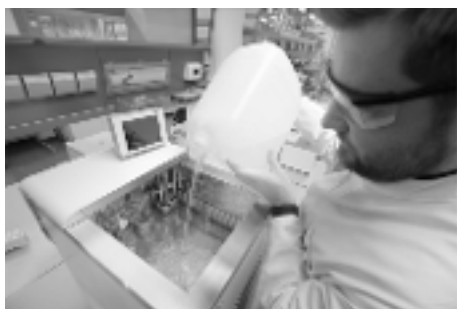
Fig. 24 : Remplissage du bain thermostaté
